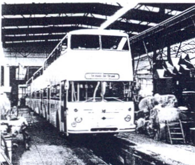
Abb. 4: Blick auf die Fertigungsstraße von O & K, Berlin-Spandau, mit den im Bau befindlichen 8 Doppeldeckern für die LVG, die im April 1972 ausgeliefert wurden (vgl. auch Titelbilder dieses Heftes).
