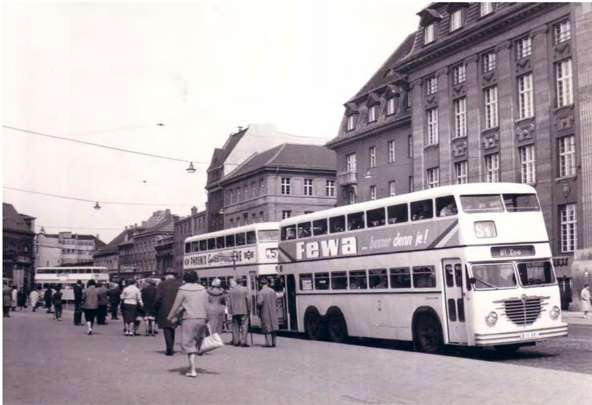
*Auf dem Münsingerplatz am Spandauer Rathaus steht ein Büssing D3U 52 auf Linie AS1 in Richtung Bf. Zoo, dahinter ein D2U, schon mit Panoramaverglasung, auf dem A5E; der D2U auf Linie A13E biegt gerade ein zur Haltestelle. Die hinter die Typenbezeichnung gestellte Zahl bedeutet – wie bei der Straßenbahn (T 24) - das Baujahr bzw. die Baureihe des Fahrzeugs.
