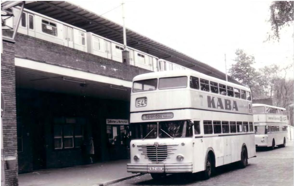
*Der Schaffnerwagen vom Typ D2U 61 wartet am U-Bf. Ruhleben auf umsteigende Fahrgäste. Dahinter ein „hochmoderner“ DE 65 auf einer der hier verkehrenden Autobus-Einmannlinien. Im Bahnhof steht ein Kleinprofilzug der Hochbahnlinie 1 vom Typ A3, abfahrtsbereit zum Schlesischen Tor. Foto: Lossberger*
