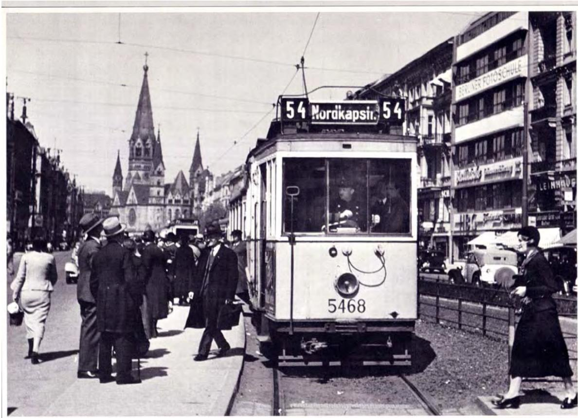
*Die Haltestelle Wittenbergplatz in den 1930er Jahren: Ein Zug der Linie 54 aus einem Triebwagen des Typs TF 13/25 mit Holzaufbau und einem Beiwagen des Typs B 24 bremsst aus. Mit der rechten Hand an der Bremskurbel stellt der Wagenführer den Zug fest, während er mit der linken die Schaltkurbel auf der letzten Bremsstufe hält. Und schon nähert sich der nächste Zug mit einem T 24 an der Spitze. Foto: E. Gnilka †*
